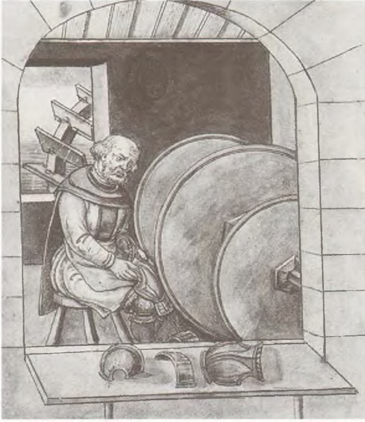
Su değirmeninden aldıkları hareketle çalışan zırh parlatma keçeleri. Hausbuch der Mendelschen Zwölfbrüderstiftung, 1571.
