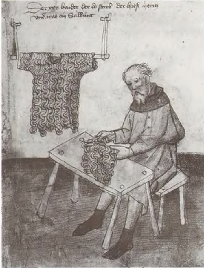
Örgü zırh yapımcısı halkaları birbirlerine eklerken.. Hausbuch der Mendelschen Zwölfbrüderstiftung, 1435-6.
