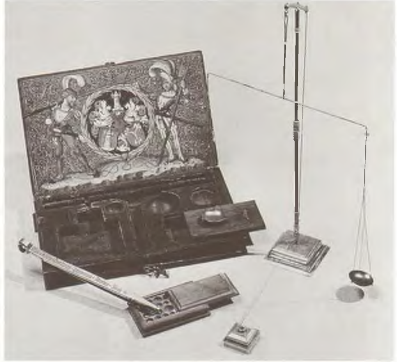
Harsdorfer altın ve kıymetli taş tartma terazisi, 1497. Kefeler altın kaplı gümüşten yapılmıştı.
