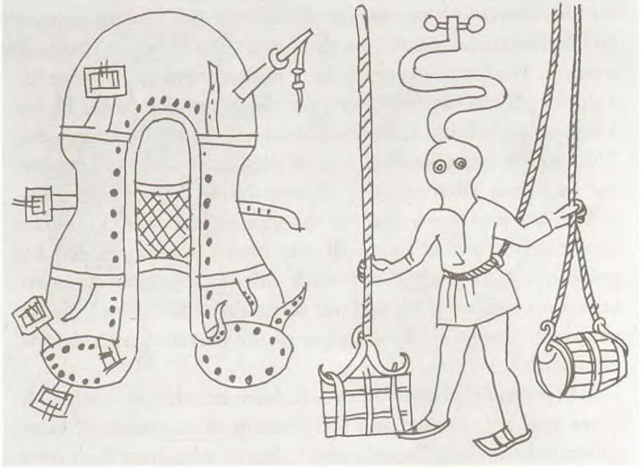
c.1430 tarihli Hüssit Savaşları el yazmasından dalgıç başlığı ve denizin dibinde, kurşun tabanlı ayakkabıları, belinde ipi, başlığından çıkan hava borusu ile modern görünümlü bir dalgıç.
